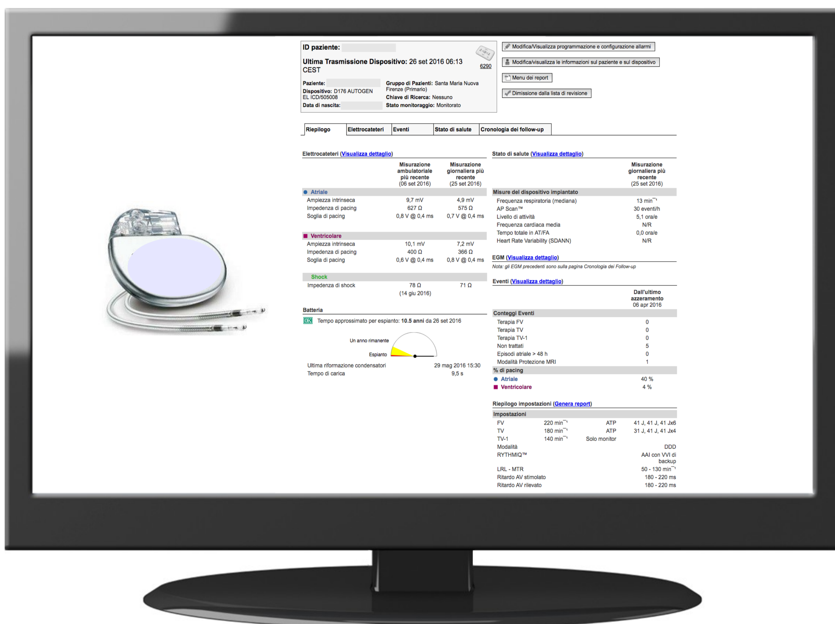
Esempio di schermata riportante i dati remoti di un defibrillatore bicamerale. Sono visibili i dati della batteria, le performance degli elettrocateri, la diagnostica sulle aritmie, gli interventi del device sia sul versante anti-bradicardico che anti-tachicardico, il livello di attività del paziente e la frequenza respiratoria mediana.
